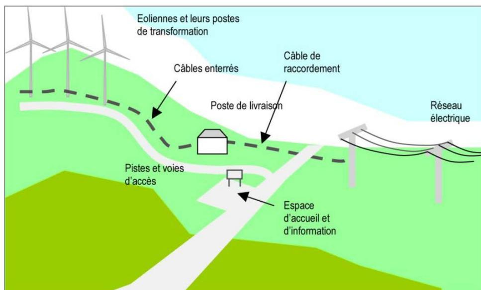
Schéma électrique d'un parc éolien
